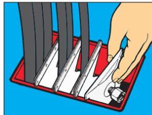
3. Durch die Verwendung von Ankerscheiben wird das Herausfallen einzelner Module verhindert. Hängen Sie deshalb zunächst alle Ankerscheiben die Kabel zu, wie im RG-Plan vorgesehen. Setzen Sie jetzt auch schon die Pressplatte ein.
