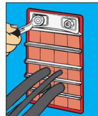
7. Die Zunge der Schlussdichtung um die Teleskopschraube legen, sodass die Schlussdichtung einführen und Spanschrauben der Schlussdichtung anziehen, bis ca. 12 mm vom Gewinde hervortreten
