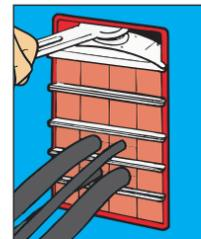
6. Die Teleskopschraube der Pressplatte anziehen, bis Abstand zwischen Oberseite Pressplatte und Innenseite Rahmen 32 mm beträgt.
