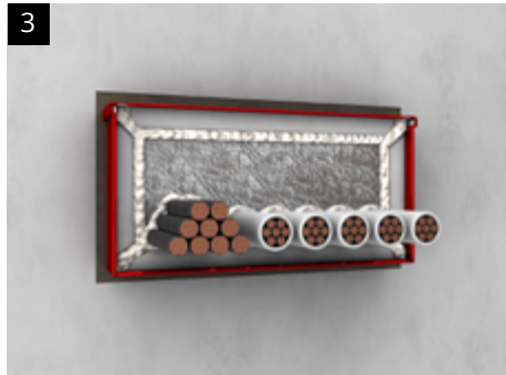
3 Elektrokabel aller Art (auch Lichtwellenleiter) mit Ausnahme von Hohlleiterkabeln. Keine Begrenzung des Gesamtleiterquerschnitts. 270 mm Box: Kabel d_a \leq 80 mm, 150 mm Box: Kabel d_a \leq 20 mm
