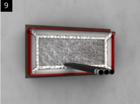
Hochdruckschläuche d_a = 14 mm aus synthetischem Gummi gemäß EN 853 vom Typ 2 SN Hansa Flex AG
