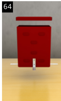
64 Deckel anbringen Verhindert das Verfüllen der FST-Kombibox beim Vergießen des Ortbetons
